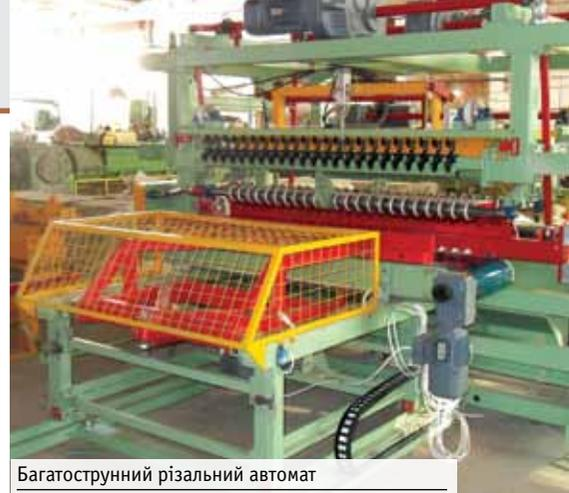
Багатострунний різальний автомат
